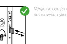
⚠ Le mouvement du cylindre doit être fluide avant de passer à l'étape suivante.
