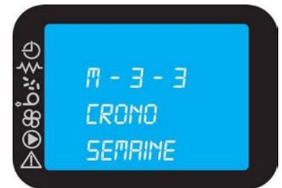
L'appareil dispose de quatre programmes hebdomadaires qui permettent quatre allumages et quatre extinctions par jour. Chaque programme propose une rotation de neuf options de réglage/activation selon le tableau suivant.
