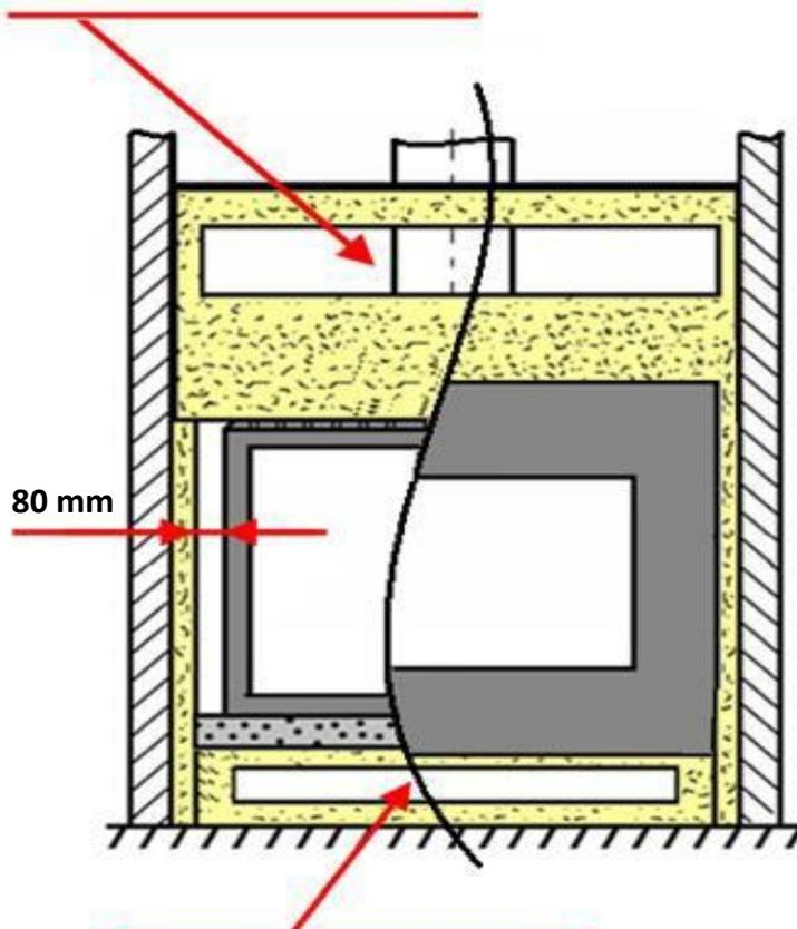
**Section de l'entrée d'air frais : 4 dm<sup>2</sup>**
